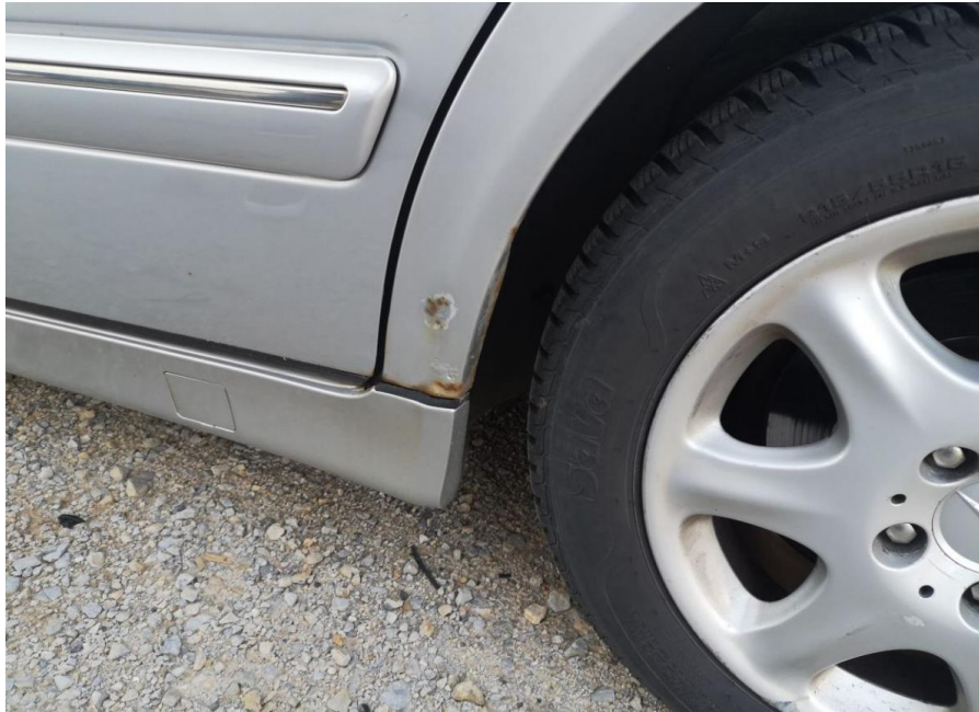
Slika 11. Prikaz oksidiranog lijevog ruba na Mercedesu i izbrazdane stražnjeg diska, [27]
