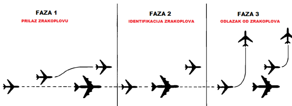
Slika 11 Postupak presretanja zrakoplova.
