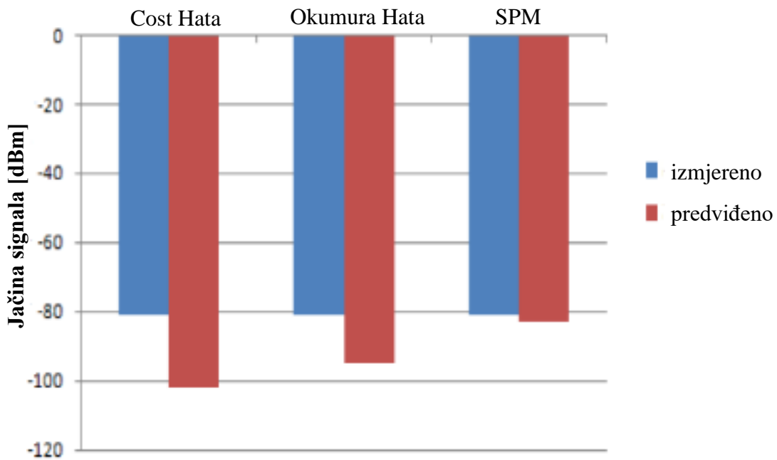
Slika 32. Predviđanja i terenska mjerenja jačine signala pojedinih modela širenja signala, [8]
