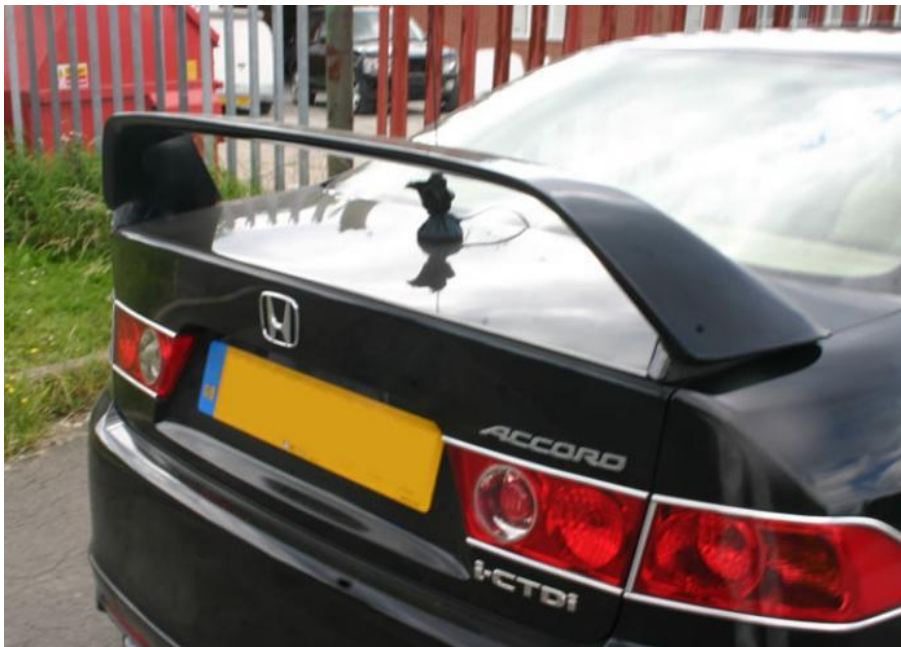
Slika 13. Naknadno ugrađen spojler na prtljažnik vozila
