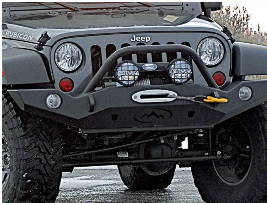
Slika 19. Naknadno ugrađen Bull bar na motorno vozilo
