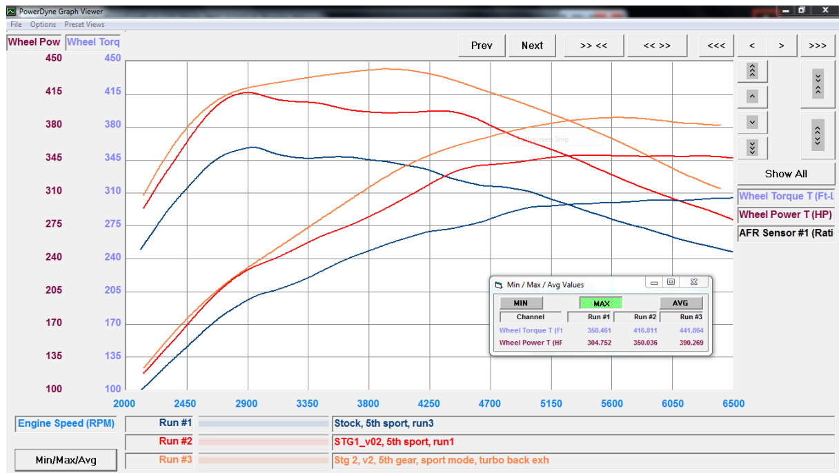
Slika 25. Dijagram povećane maksimalne snage motora
