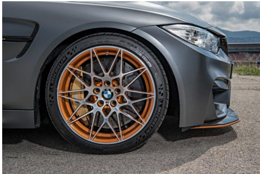
Slika 6. Pneumatik 275/35 R19 na vozilu BMW M4 GTS
