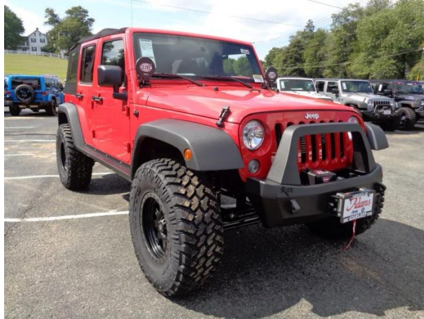
Slika 7. Jeep Wrangler s ugrađenim MUD terrain pneumaticima
