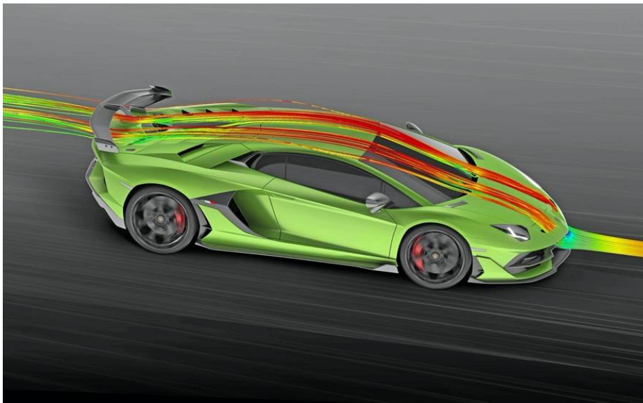
Slika 11. Strujanje zraka kroz karoseriju
