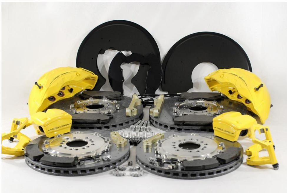
Slika 1. Mercedes G klasa - karbon keramičke disk kočnice
