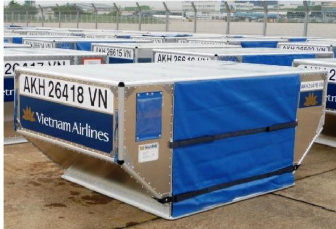
**Slika 17.** Zrakoplovni kontejner
