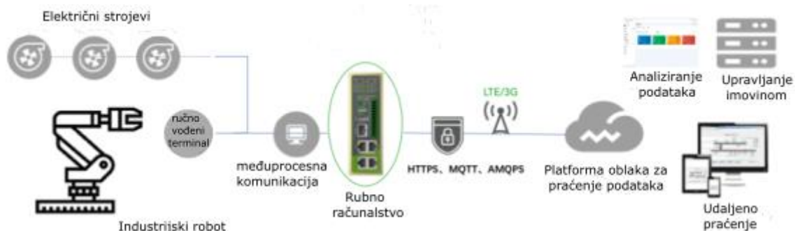
Slika 18. Udaljeno održavanje u robotici
