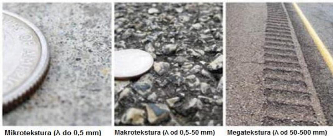
Slika 18. Prikaz mikro, makro i megastrukture vozne površine
