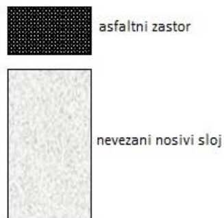
Slika 6. Nosivi sloj od nevezanog kamenog agregata
