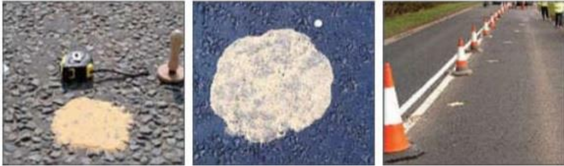
Slika 20. Određivanje dubine teksture pjeskarenjem
