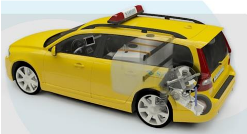
Slika 13. SARSYS Volvo friction tester (SVFT) vozilo
