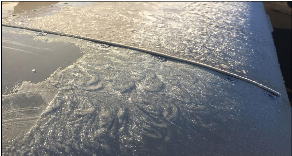
Slika 1. Hrapavi led na krilu zrakoplova [3]
