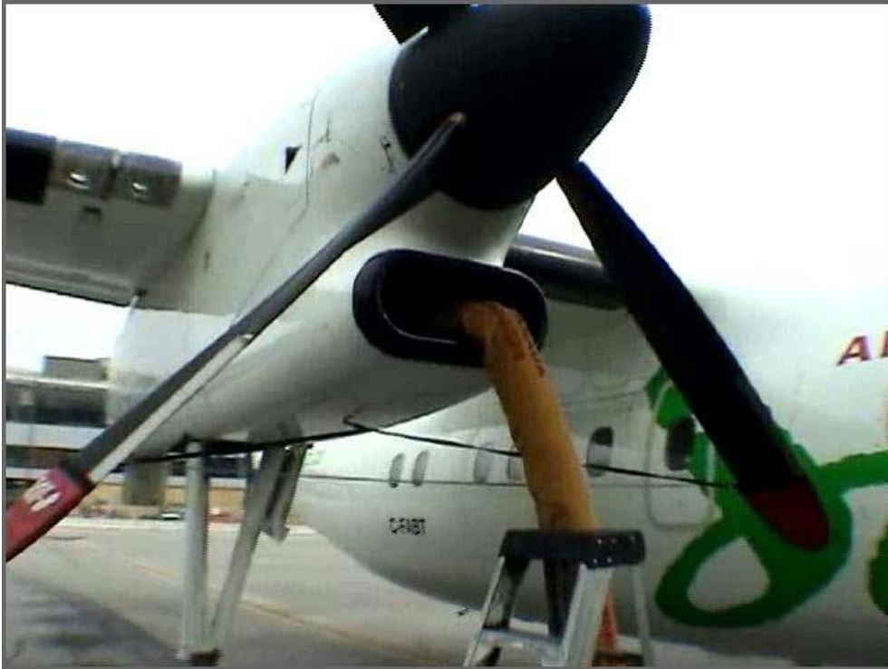
Slika 7. Odleđivanje toplim zrakom [10]
