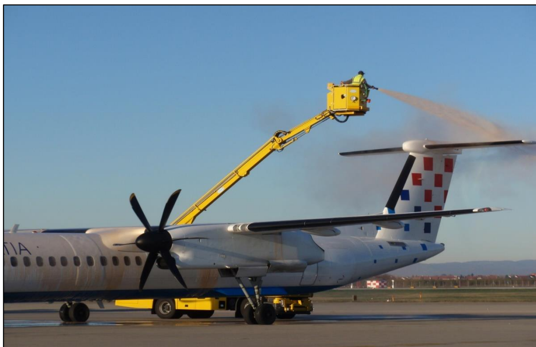
Slika 5. Odleđivanje repnih površina kemikalijom Type 1[8]
