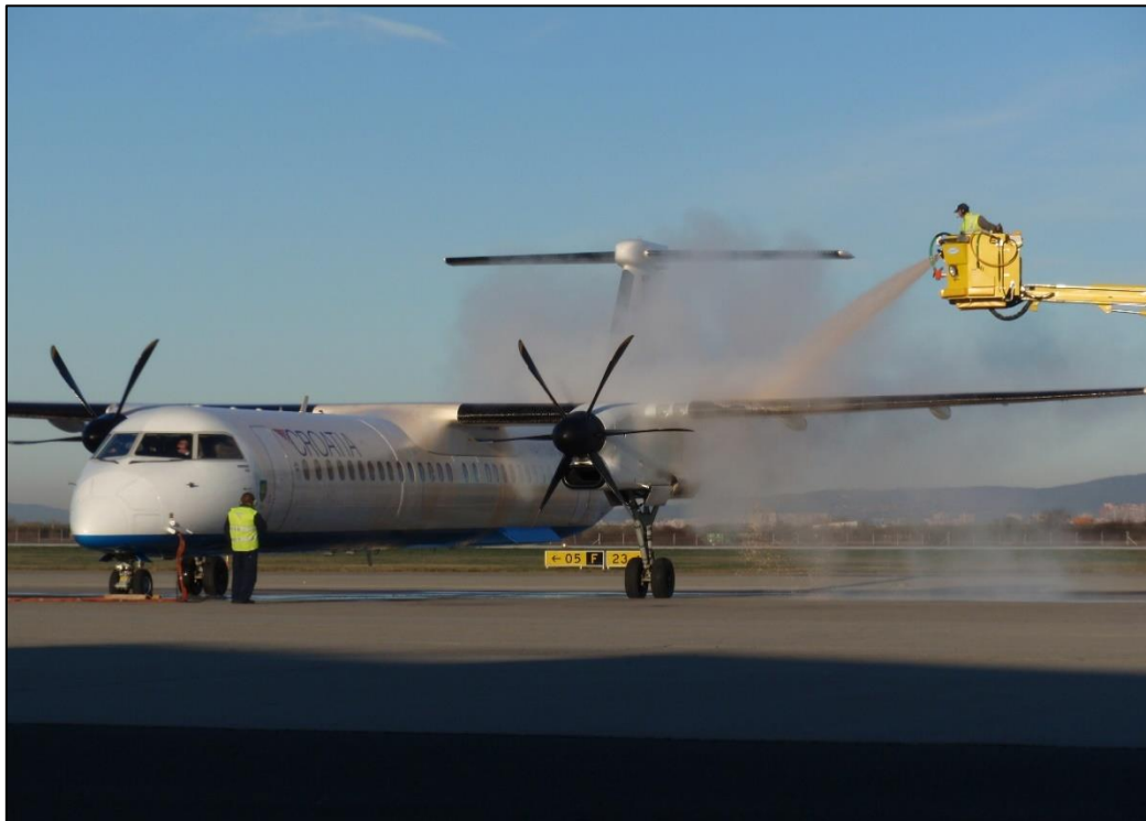
Slika 4. odleđivanje krila kemikalijom Type 1[8]
