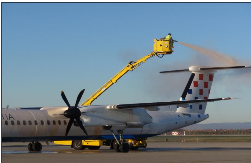
Slika 5. Odleđivanje repnih površina kemikalijom Type 1[8]
