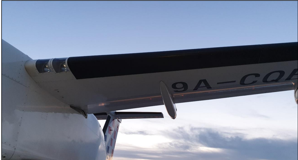
Slika 9. Gumeni segmenti na krilu [8]
