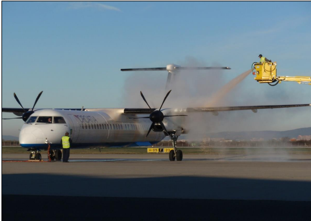
Slika 4. odleđivanje krila kemikalijom Type 1[8]
