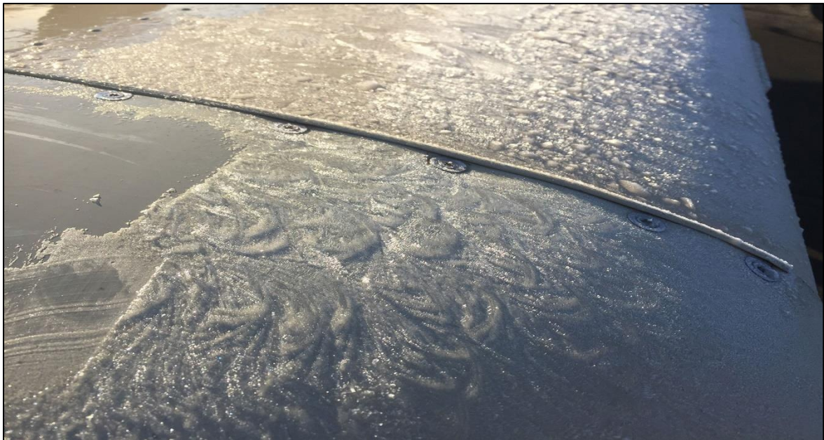
Slika 1. Hrapavi led na krilu zrakoplova [3]
