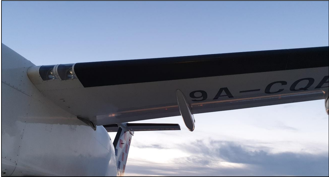
Slika 9. Gumeni segmenti na krilu [8]
