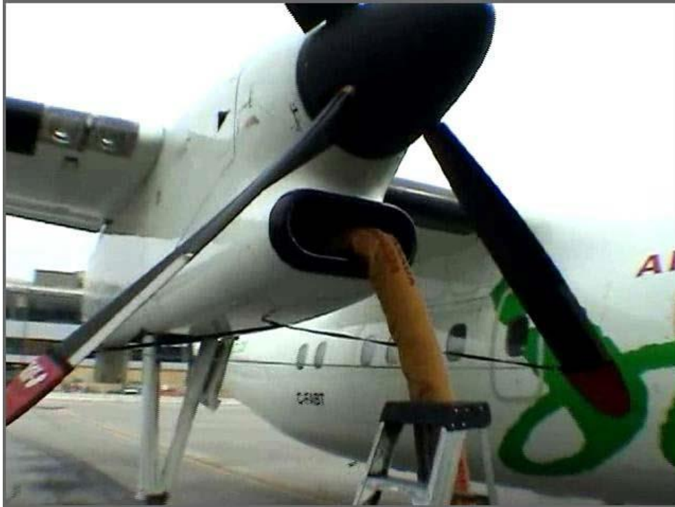
Slika 7. Odleđivanje toplim zrakom [10]
