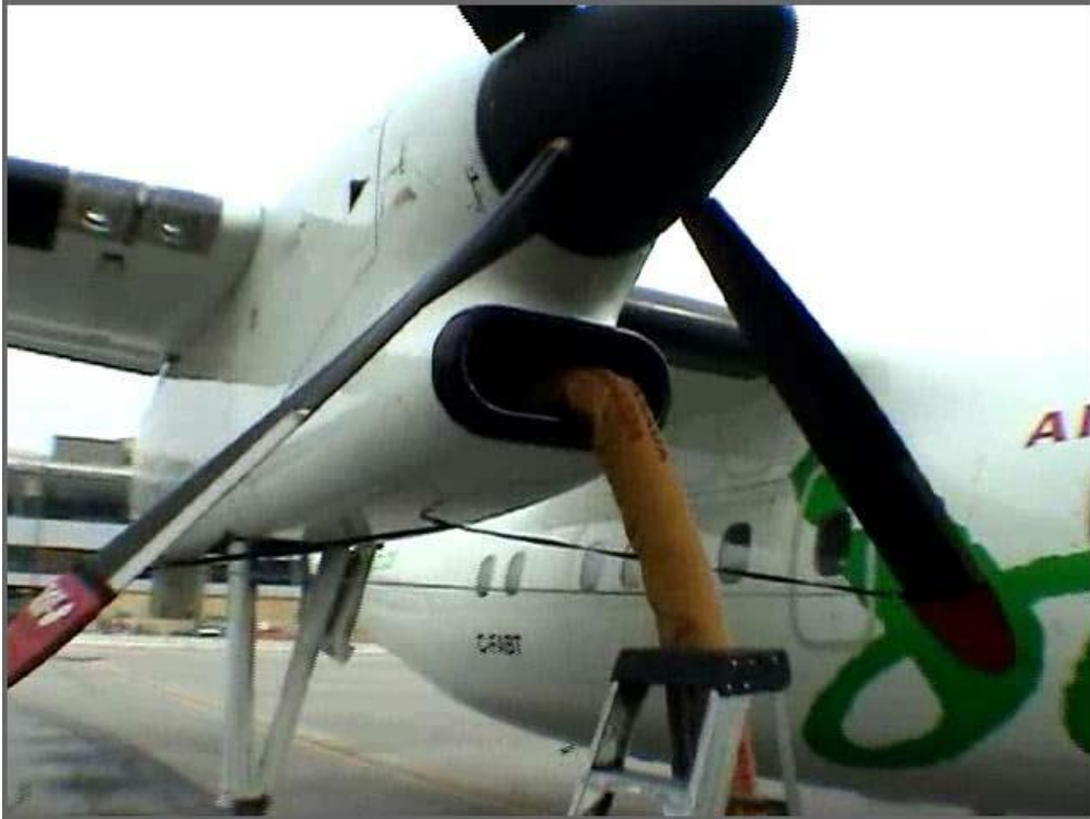
Slika 7. Odleđivanje toplim zrakom [10]
