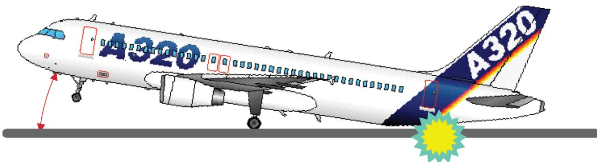
Slika 7. Udarac zrakoplova zbog prevelikog napadnog kuta
