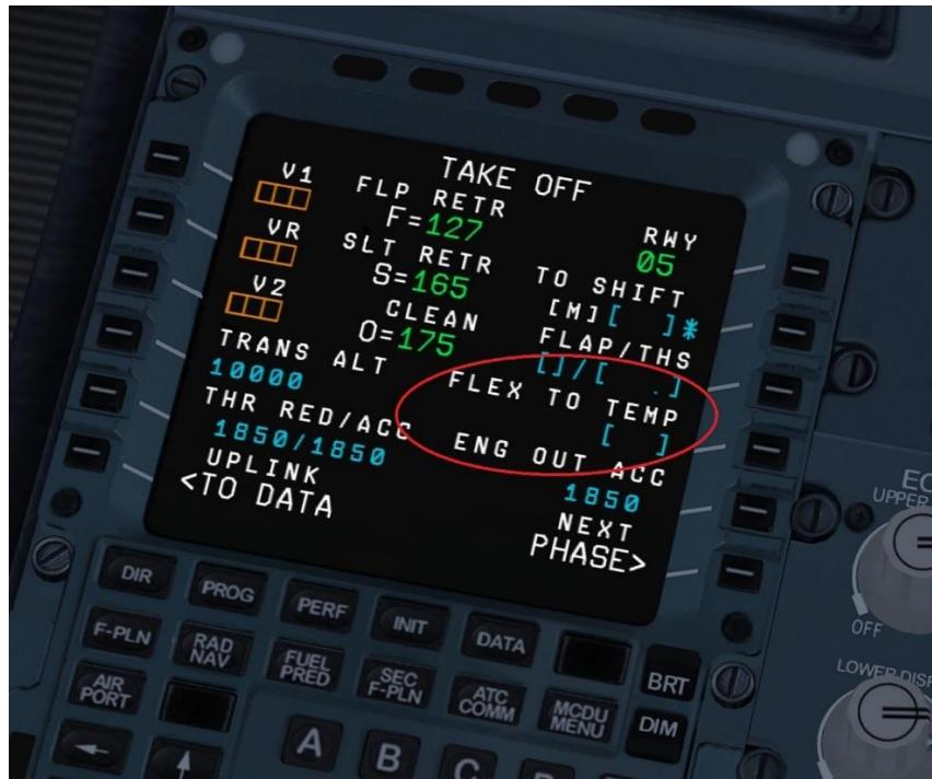
Slika 12. Prikaz mesta unosa  $T_{FLEX}$  u MCDU na zrakoplovu Airbus A320
