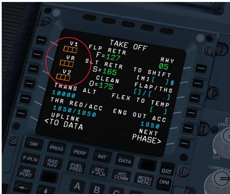
Slika 1. Prikaz mjesta unosa brzina u MCDU u Airbusu A320
