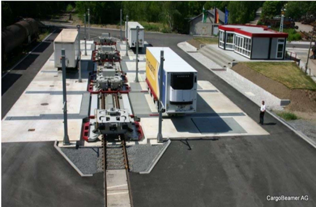
Slika 6. Prikaz CargoBeamer paralelnog utovara i istovara
