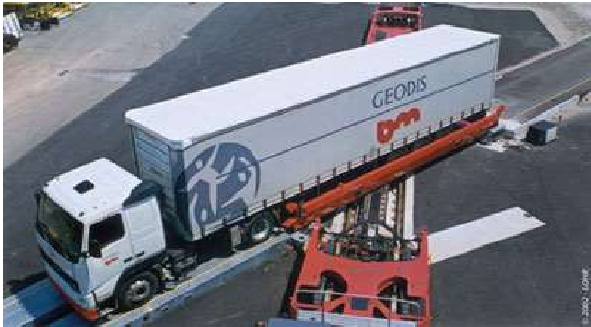
Slika 7. Bočni ukraj pomoću Modalohr tehnologije
