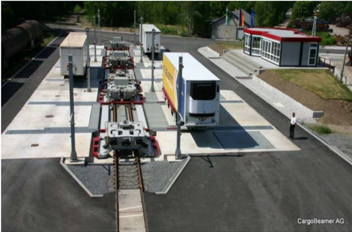
Slika 6. Prikaz CargoBeamer paralelnog utovara i istovara
