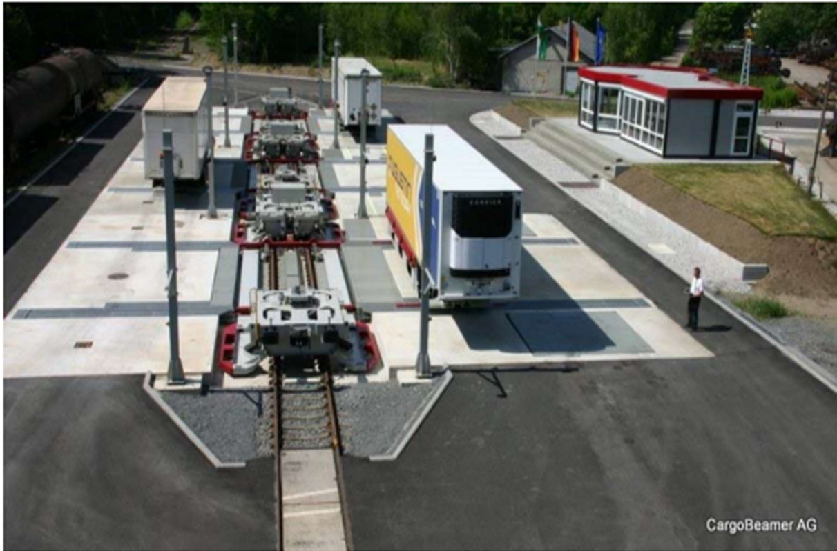
Slika 6. Prikaz CargoBeamer paralelnog utovara i istovara
