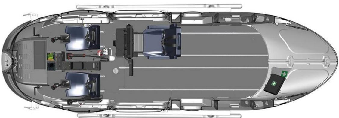
**Slika 7.** Konfiguracija helikoptera EC135 za policijski nadzor
