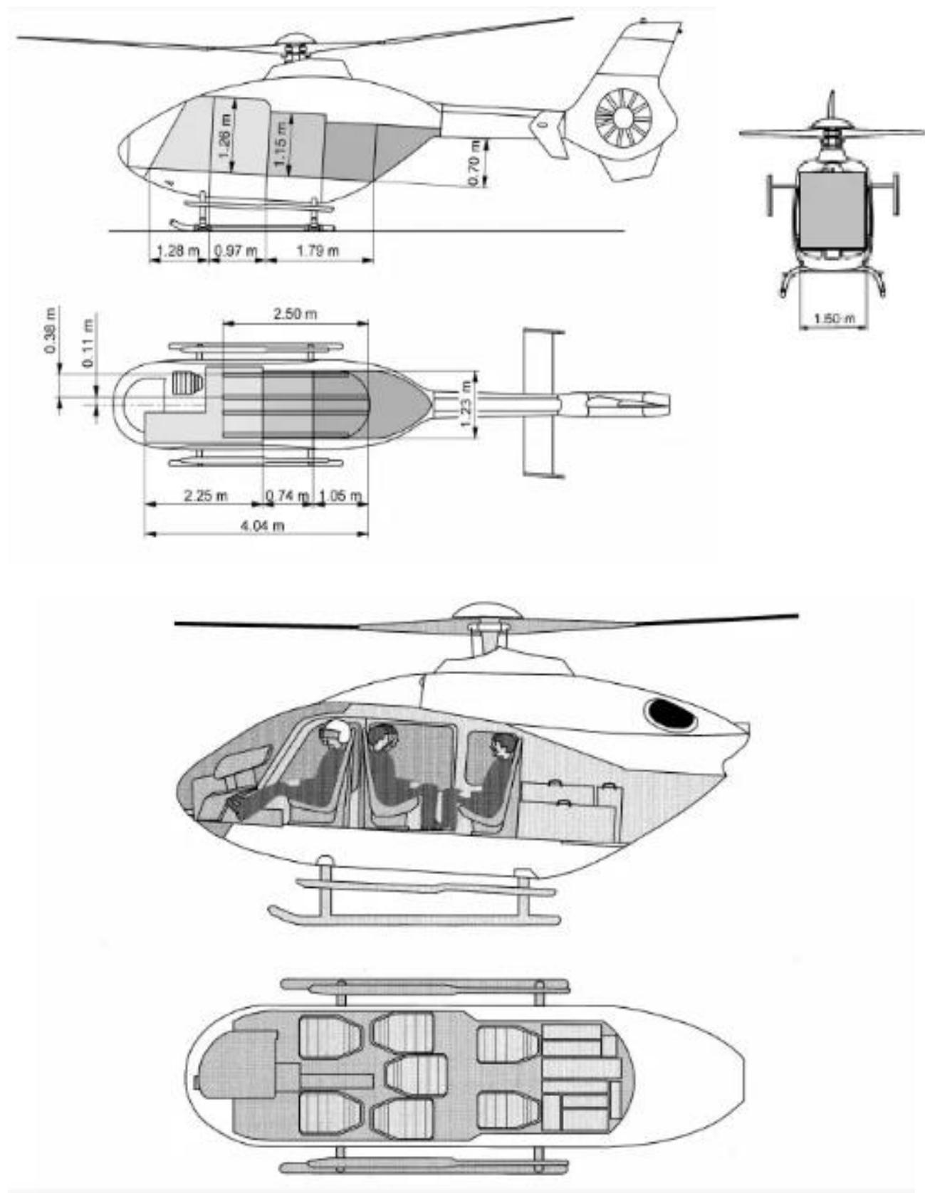
Slika 4. Unutarnje dimenziije helikoptera EC135
