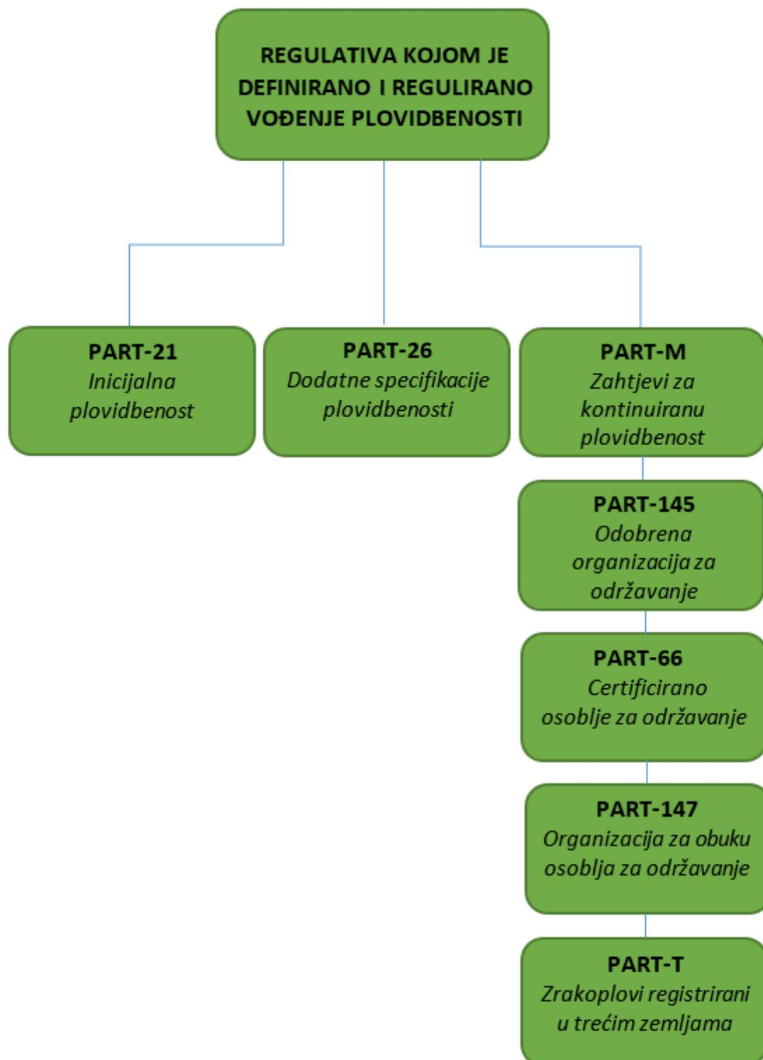
**Slika 1.** EASA zrakoplovni propisi vezani uz plovidbenost zrakoplova
