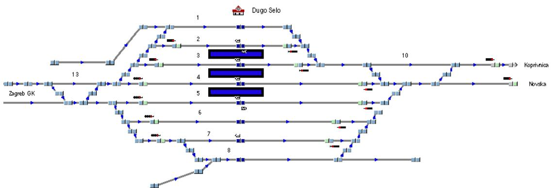
**Slika 3.** Shematski prikaz kolosijeka u kolodvoru Dugo Selo iz programa OpenTrack
