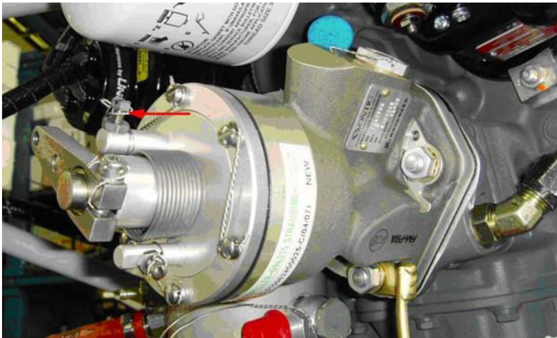
Slika 9. Woodward X210XXX regulator stalne brzine vrtnje [7]
