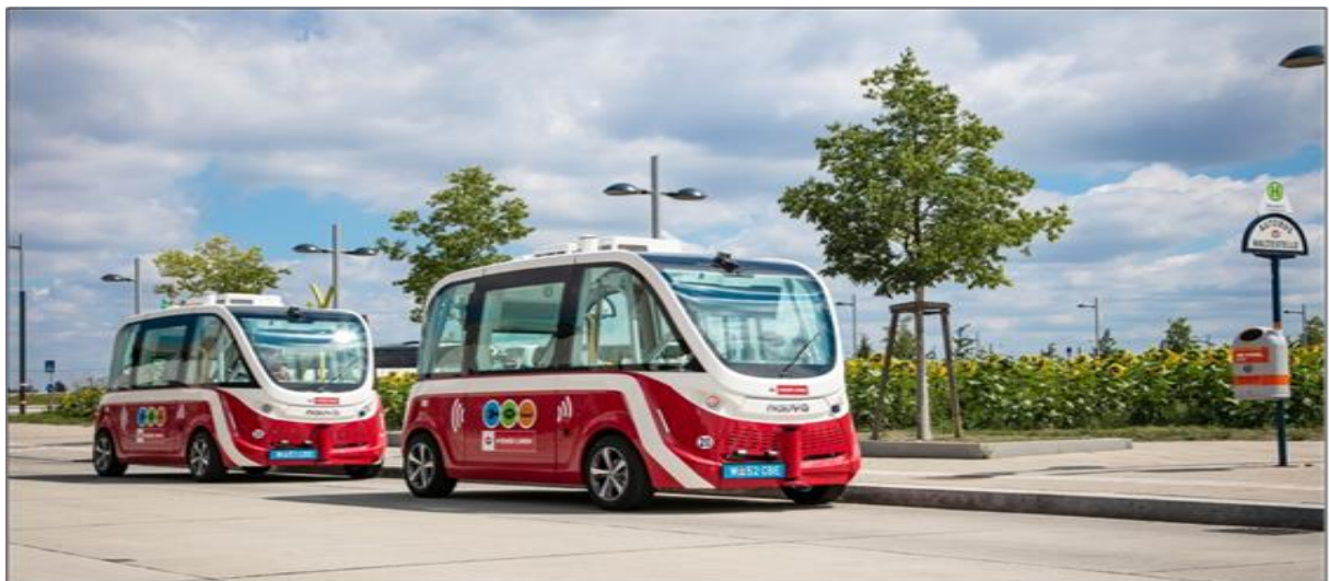
Slika 39. Primjer autonomnog autobusa Navya
