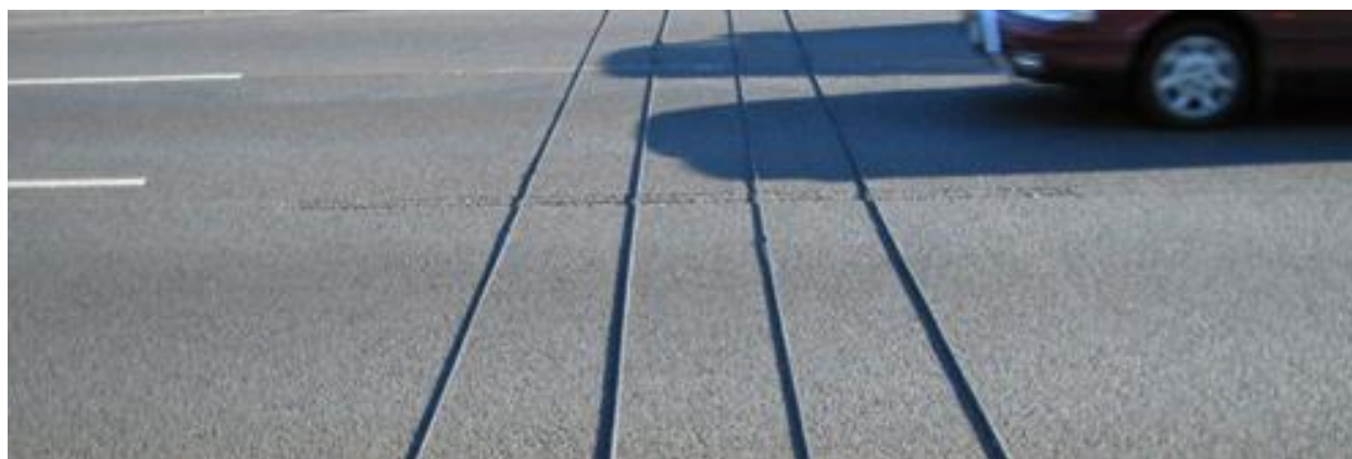
Slika 18. Automatsko brojanje prometa sa pneumatskim brojanjem
