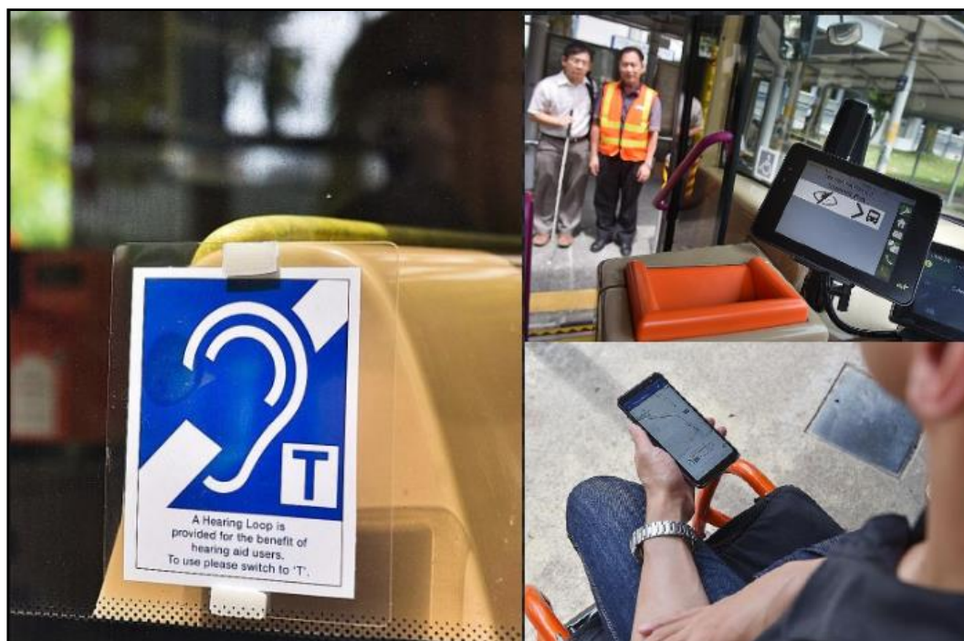
Slika 19. Korištenje zvučnih najava putem T-petlje i aplikacije za mobilni telefon u Singapuru [22]
