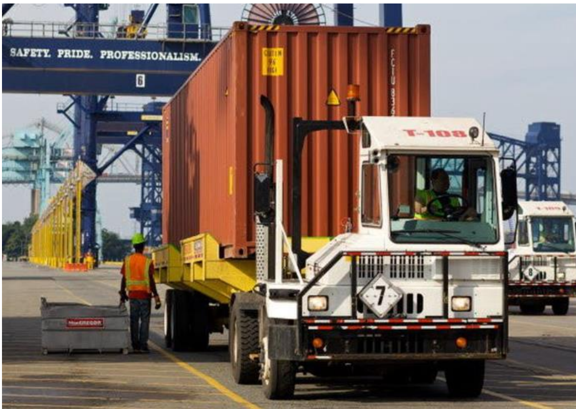
Slika 21. Tegljač sa kontejnerskom prikolicom
