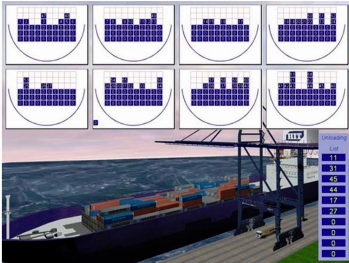
Slika 6. Prikaz informacija kontrolnog tornja unutar korisničkog sučelja prilikom korištenja CAVE simulacije Izvor: Lau H., Chan L., Wong R.: A virtual container terminal simulator for the design of terminal operation, Int J Interact Des Manuf (2007) 1:107–113
