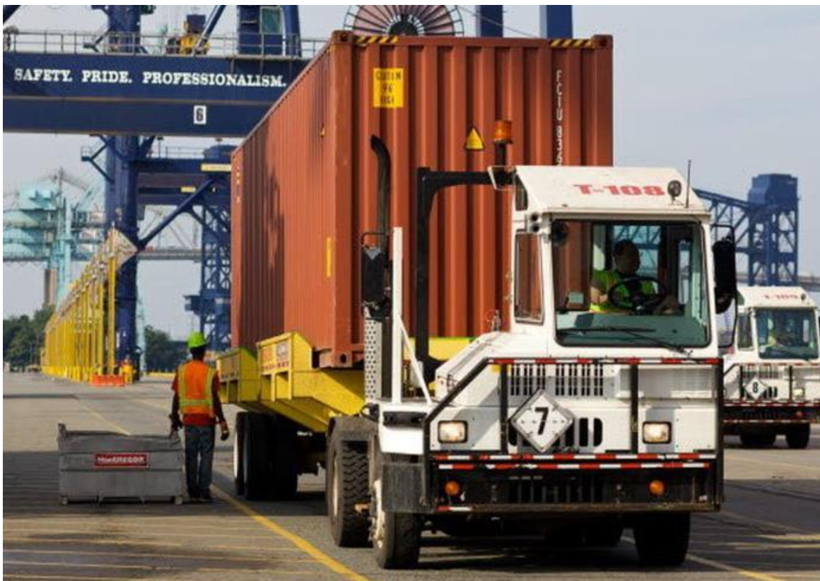
Slika 21. Tegljač sa kontejnerskom prikolicom
