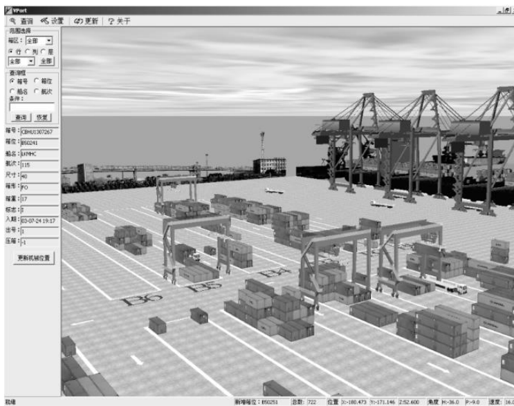
Slika 8. Prikaz na bazi virtualne stvarnosti planiranja kontejnerskog terminala
