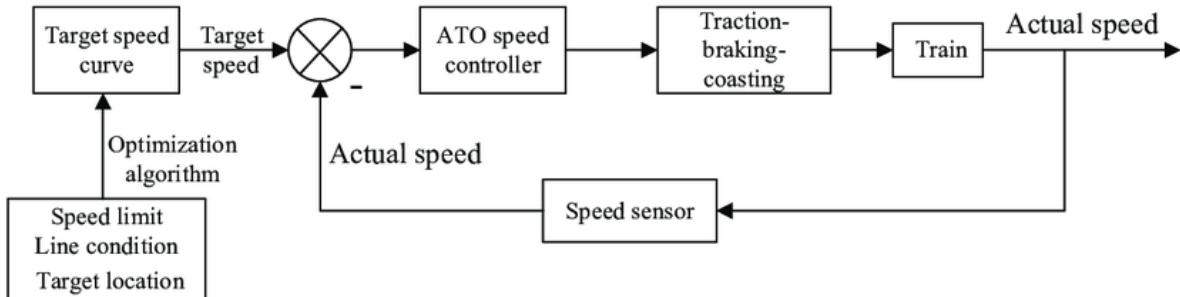
**Slika 6.** Shema strukture ATO putne jedinice instalirane na vozilu
