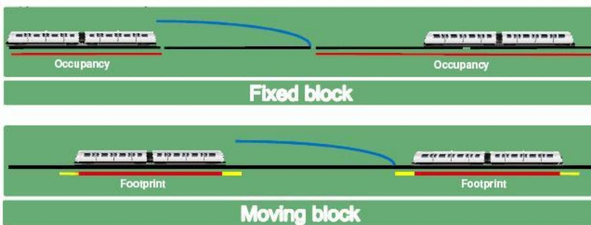
Slika 10. Prikaz vođenja vlakova fiksnim blokom i pokretnim blokom
