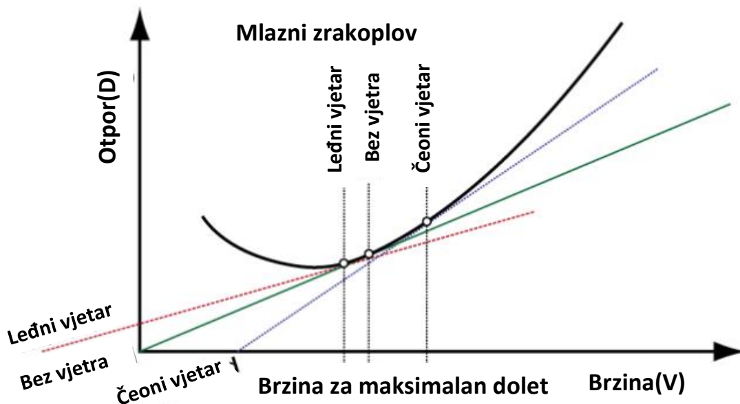
Slika 2. Graf sile otpora i brzine pri različitim komponentama vjetra [3]
