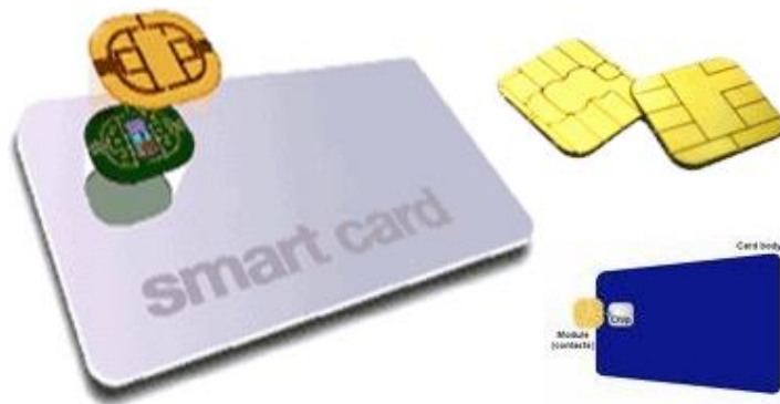
Slika 3.1. Presjek pametne kartice, [49].
