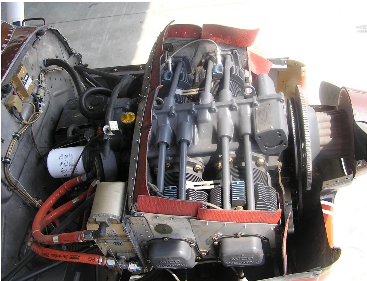
Slika 4. Zrakoplovni klipni motor oznake O-320-H2AD
