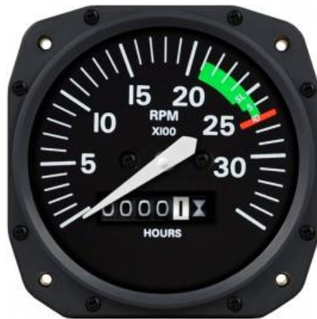
Slika 7. Prikaznik tahometra sa karakterističnim postavkama snage
