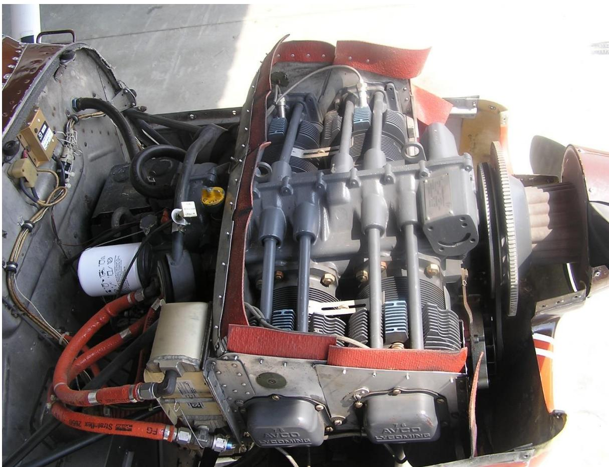
Slika 4. Zrakoplovni klipni motor označke O-320-H2AD
