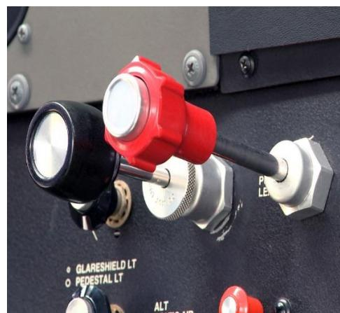
Slika 8. Ručice snage i smjese na zrakoplovu Cessna 172
