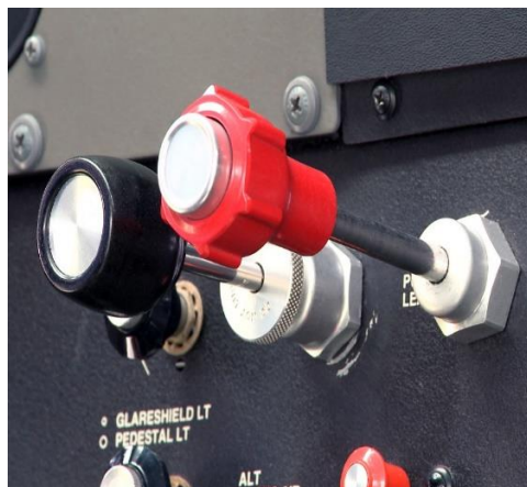
Slika 8. Ručice snage i smjese na zrakoplovu Cessna 172
