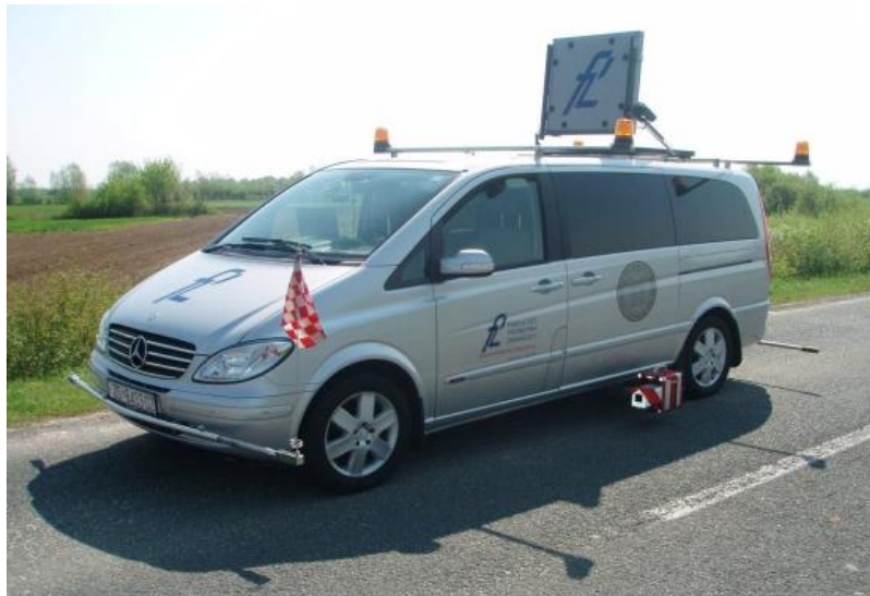
Slika 18. Mjerno vozilo Fakulteta prometnih znanosti s montiranim uređajem ZDR 6020
