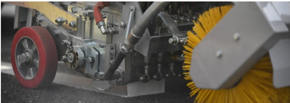
Slika 11. Prikaz izlivanja vruće termoplastike na kolnik pomoću Extrudera
