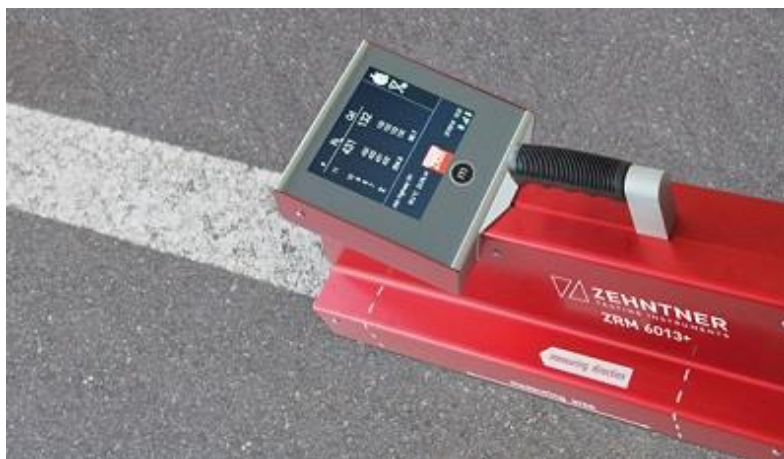
Slika 17. Mjerenje vidljivosti oznaka na kolniku pomoću statičkog retroreflektometra
