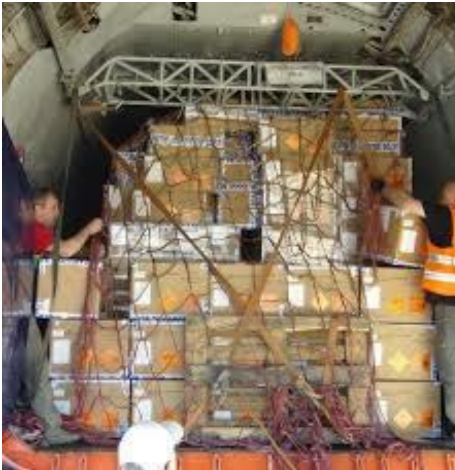
Slika 27. Primjer vezanja opasne robe u zrakoplovu
