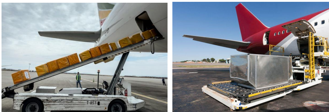
Slika 19. Komadni utovar pošiljaka (lijevo) i utovar putem ULD-a (desno)
