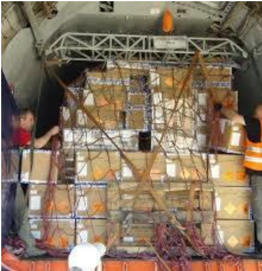
Slika 27. Primjer vezanja opasne robe u zrakoplovu
