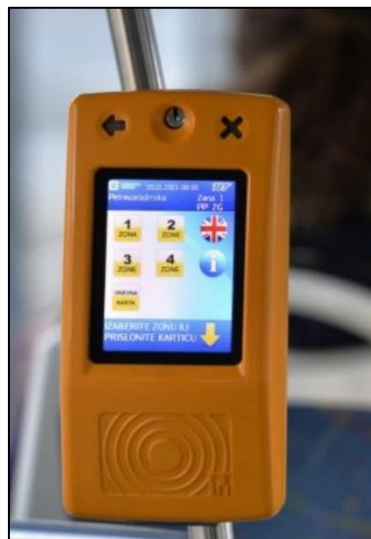
Slika 4. Validator u vozilu Zagrebačkog električnog tramvaja izvor: [7]
