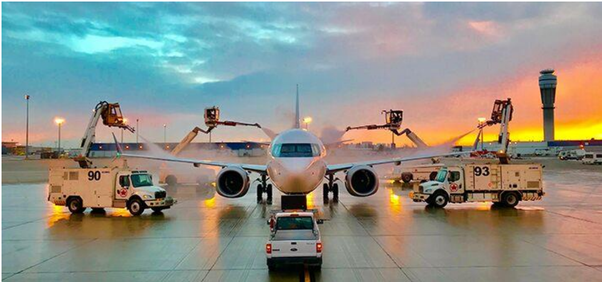
Slika 13. Proces odleđivanja zrakoplova
