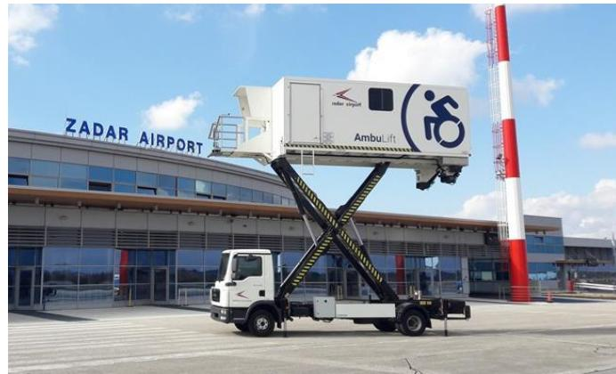
**Slika 3.** Ambulift vozilo za izlazak putnika sa smanjenom pokretljivošću iz zrakoplova
