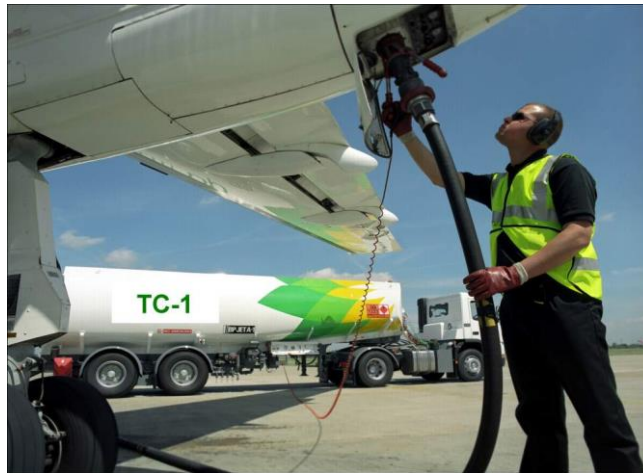
Slika 6. Opskrba zrakoplova gorivom uz pomoć cisterne
