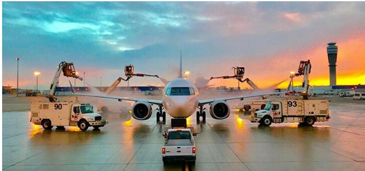
**Slika 13.** Proces odleđivanja zrakoplova
