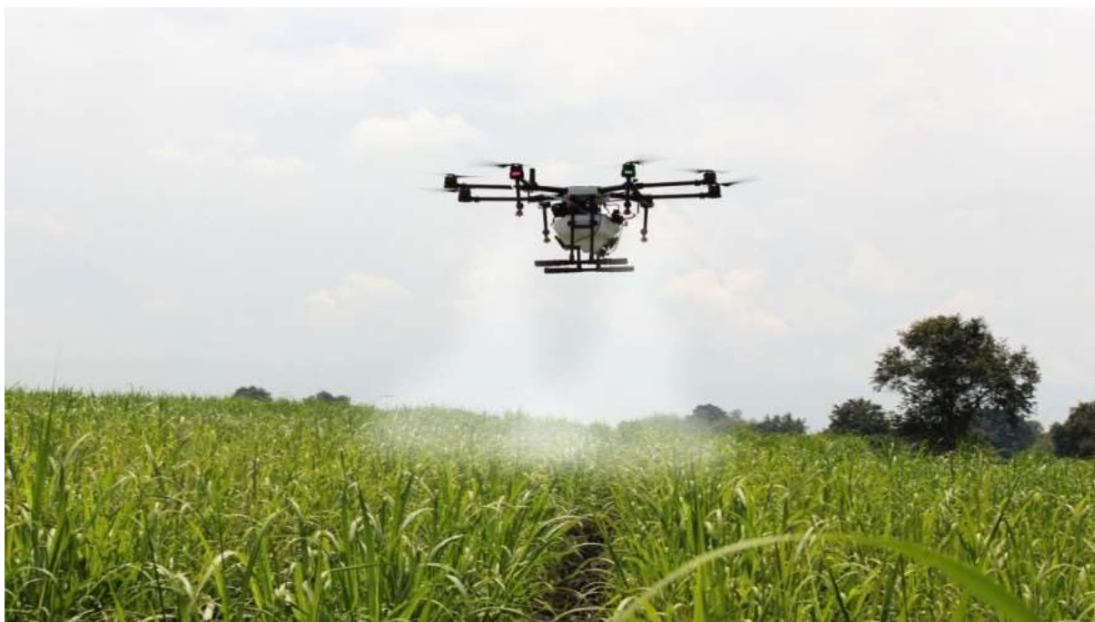
Slika 6. Prskanje pesticida pomoću drona, [12].
