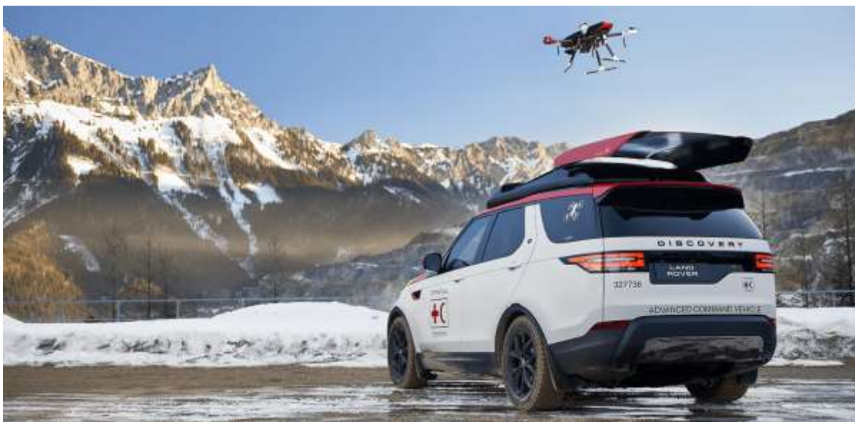
Slika 19. Prilagođeni Land Rover Discovery opremljen dronom sa termičkom kamerom, [27].
