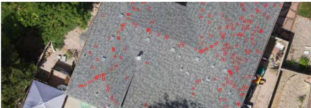
Slika 24. Vršenje inspekcije dronovima u svrhu procjene oštećenja na imovini, [27].
