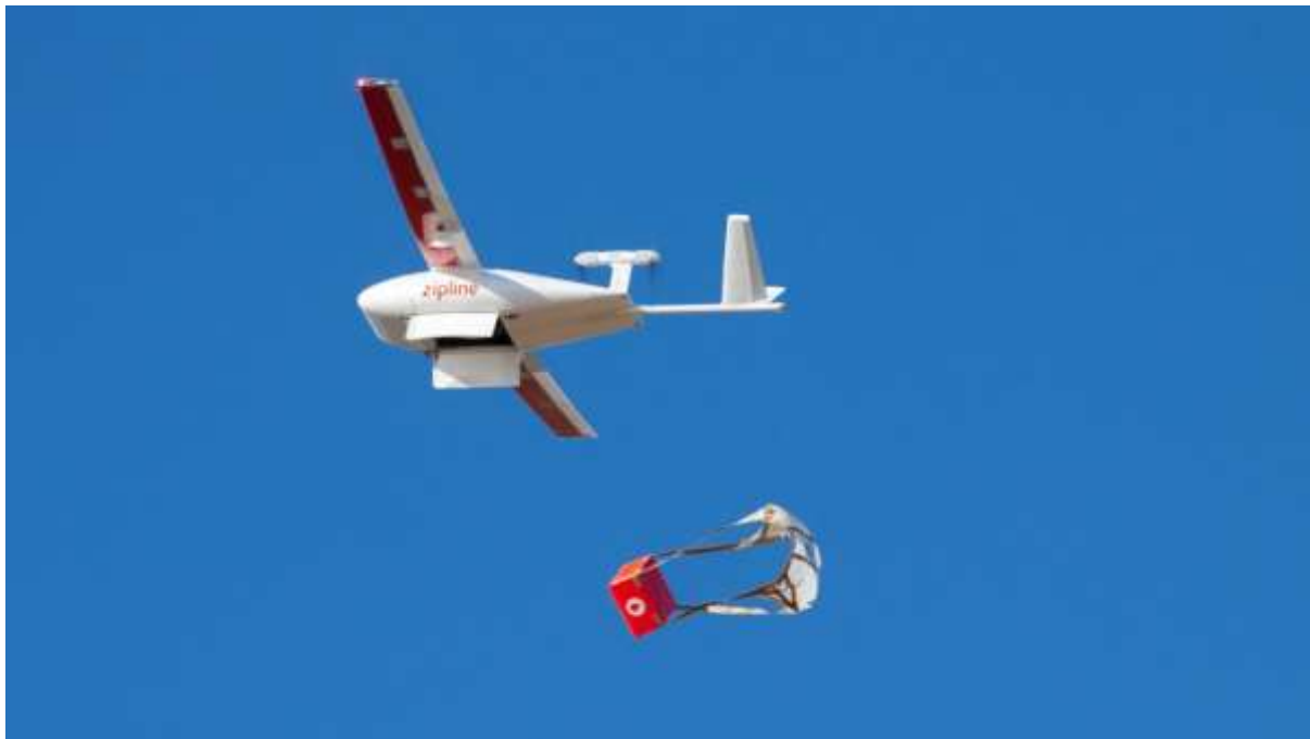
Slika 11. Zipline bespilotna letjelica u toku ispuštanja tereta na predviđenoj destinaciji, [19].
