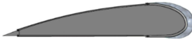
Slika 2.6. Mješoviti led na aeroprofilu [5]
