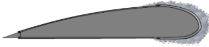
Slika 2.5. Neprozirni led na aeroprofilu [5]
