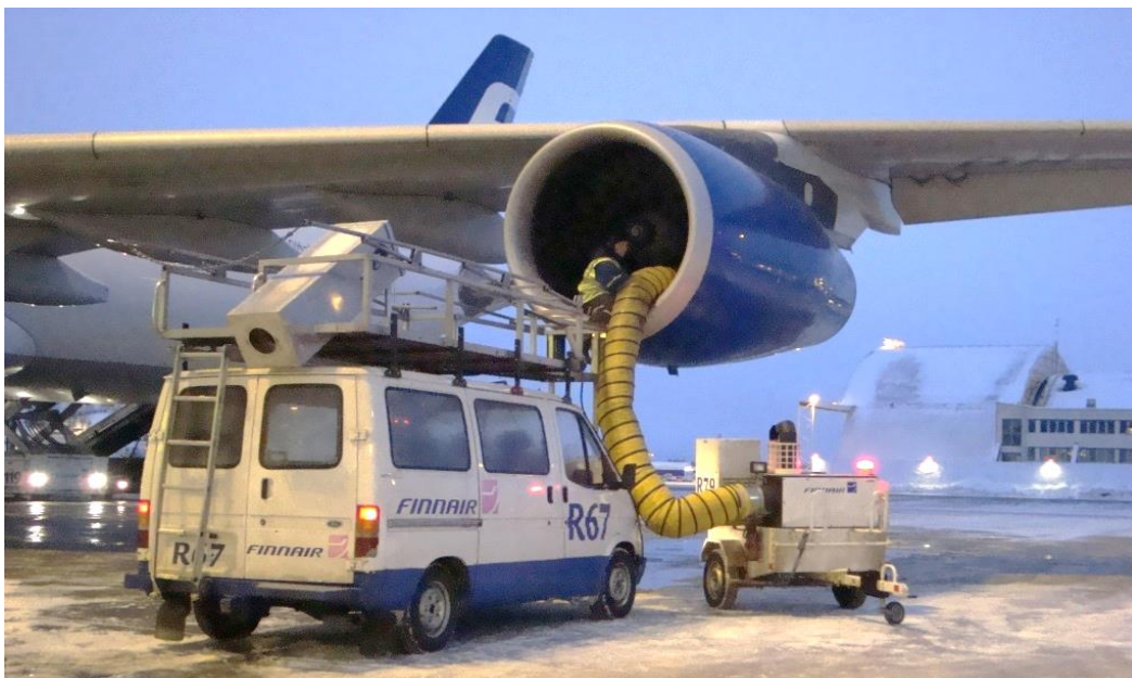
Slika 4.6. Odleđivanje vrućim zrakom [26]
