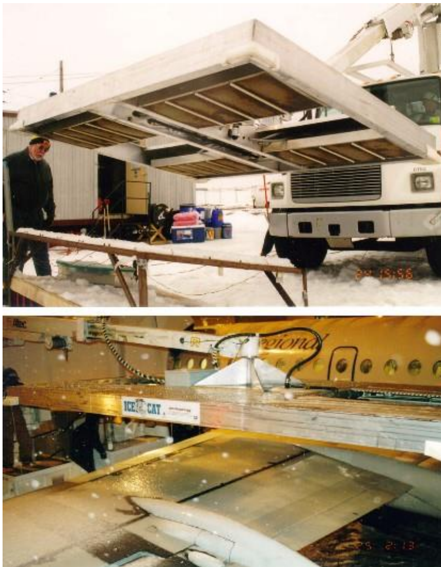
Slika 6.2. Mobilni infracrveni sustav [25]
