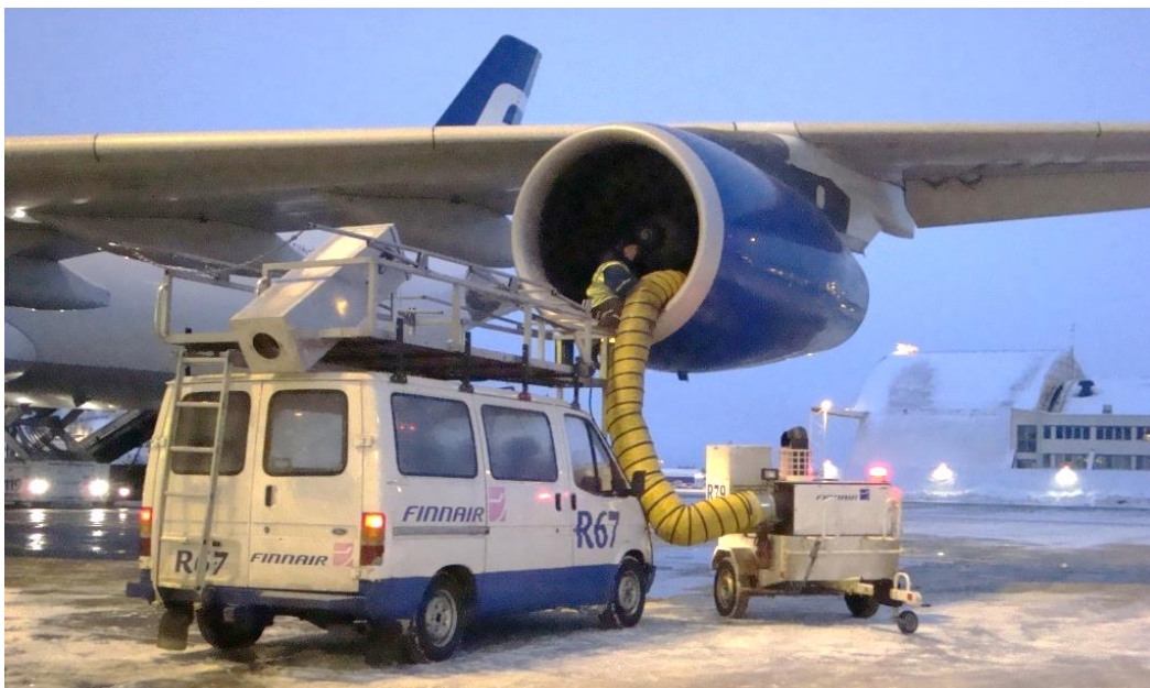
Slika 4.6. Odleđivanje vrućim zrakom [26]
