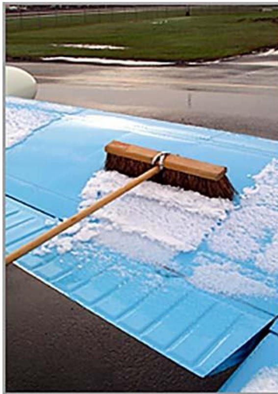
Slika 4.2. Uklanjanje kontaminanta pomoću metle [20]
