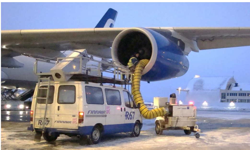
Slika 4.6. Odleđivanje vrućim zrakom [26]
