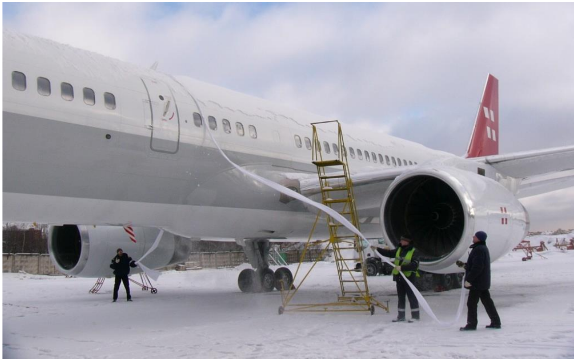
Slika 4.3. Uklanjanje kontaminanta pomoću užeta [22]
