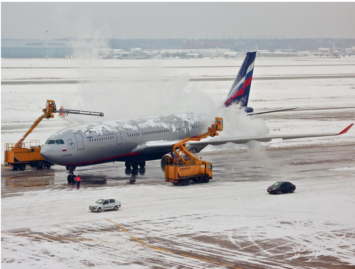
Slika 5.1. Stajanka za odleđivanje i zaštitu od zaleđivanja [33]
