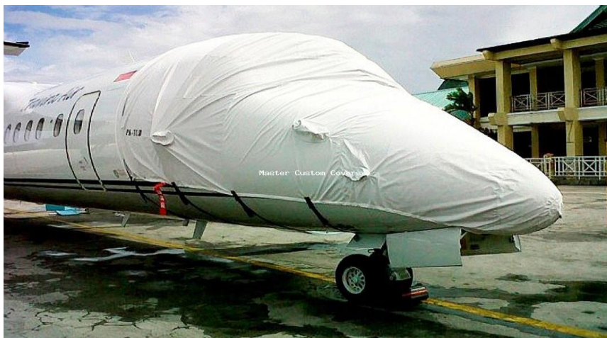
Slika 4.1. Pokrivač za nos zrakoplova i prozore pilotske kabine [21]
