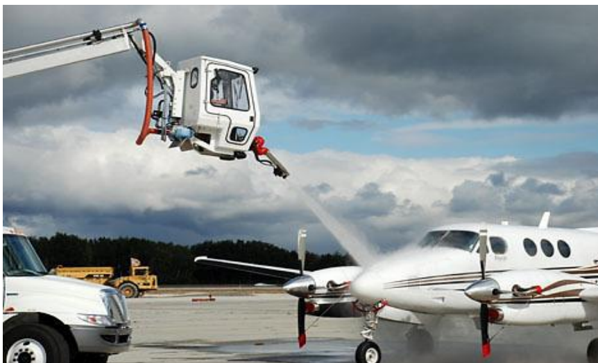
Slika 4.4. Uklanjanje kontaminanta stlačenim zrakom [24]
