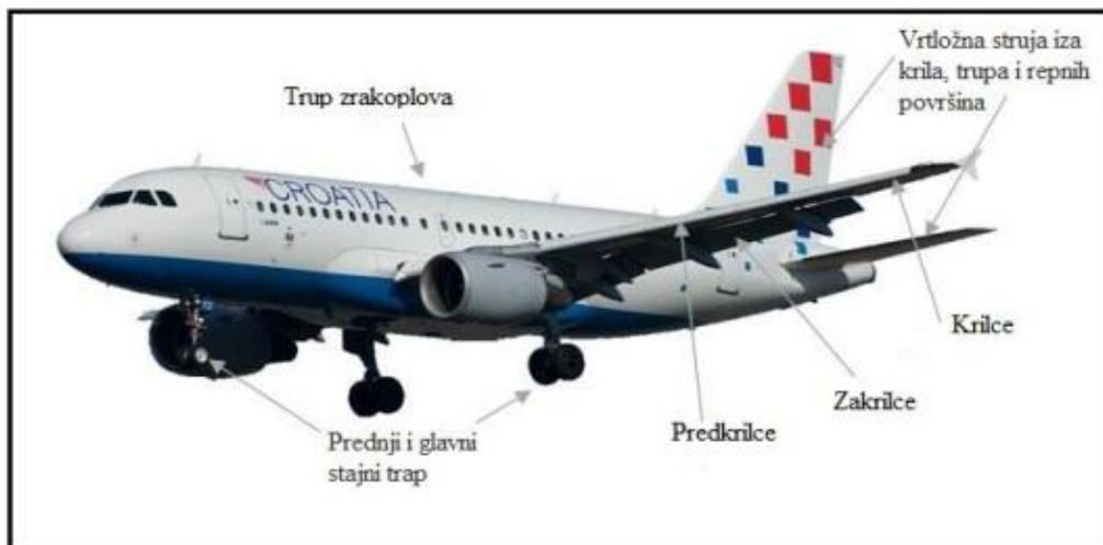
Slika 3. Izvori buke uzrokovane strukturom zrakoplova, [2]
