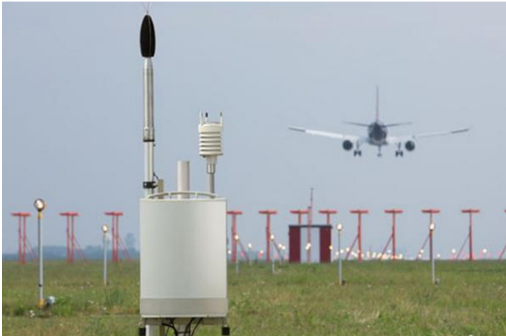
Slika 9. Prikaz NMT stanice s odgovarajućim mikrofonom, [26]
