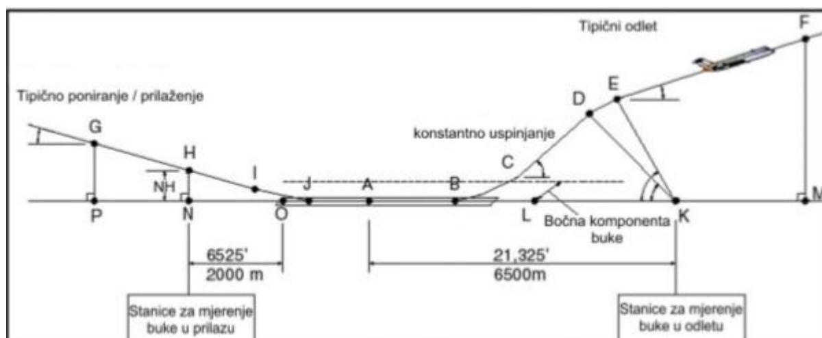
Slika 7. Točke za mjerjenje buke u svrhu certifikacije zrakoplova, [3]
