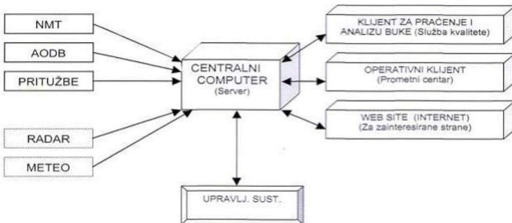
**Slika 11.** Shematski prikaz sustava za mjerjenje buke, [15]
