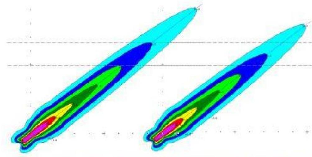
**Slika 16.** Prikaz odnosa karata buke standardnog postupka pri polijetanju (lijevo) i operativnog postupka kontinuiranog penjanja zrakoplova (desno), [27]
