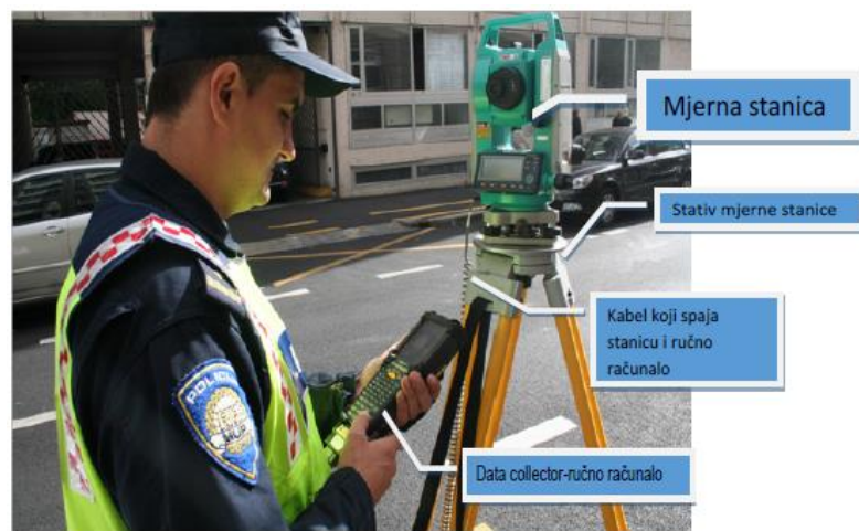
Slika 14. Totalna mjerna stanica Izvor:[16]
