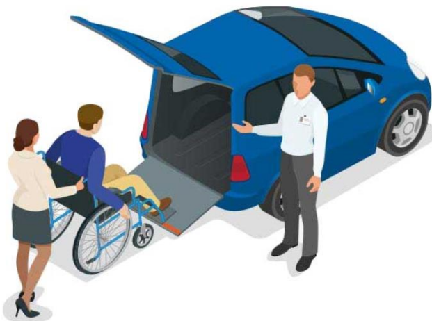
Slika 12. Stražnja rampa za ulaz vozača u invalidskim kolicima [19]
