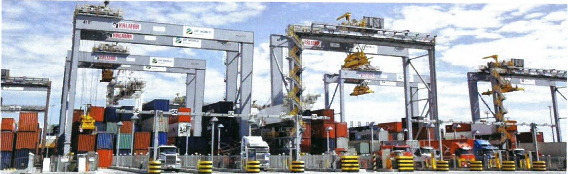
Slika 18. Automatski ukrcaj kontejnera na vozila
