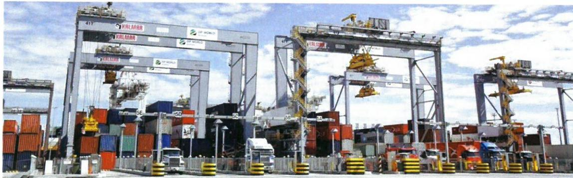
**Slika 18.Automatski ukrcaj kontejnera na vozila**
