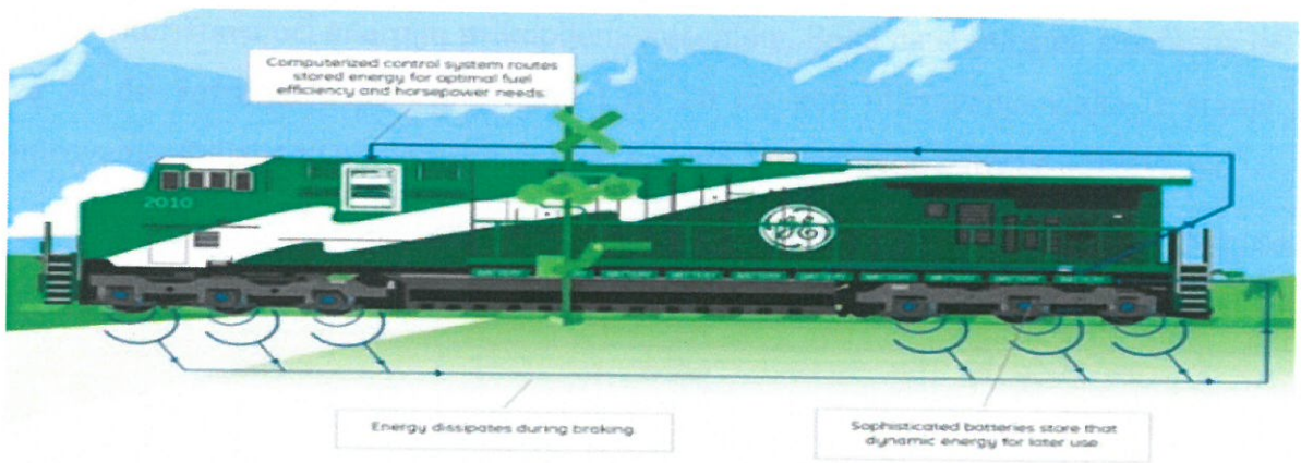
Slika 1. Shema GE hibridne lokomotive
