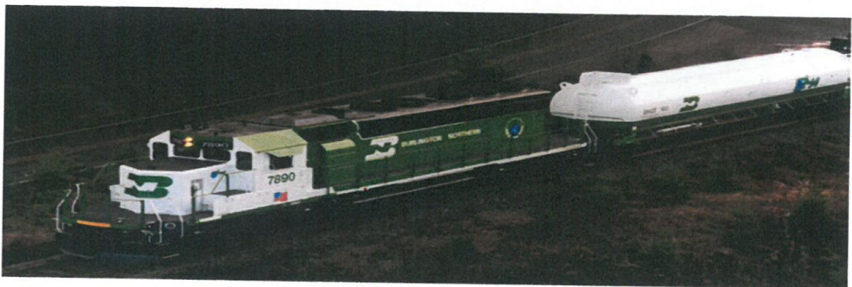
Slika 10. Vlak pogonjen ukapljenim prirodnim plinom (LNG)
