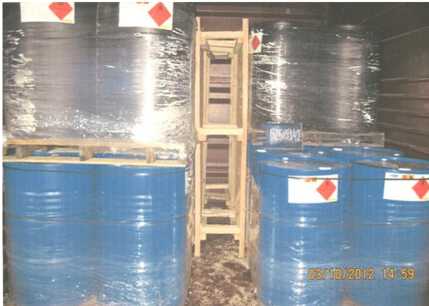
Slika 3. Način postavljanja robe u dva reda u teretni prostor vagona
