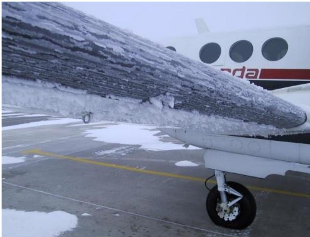
**Slika 16.** Prikaz leda na napadnim ivicama krila zrakoplova [22]
