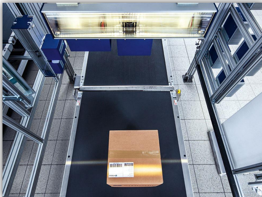
Slika 6. Prikaz primjene OCR tehnologije u poštanskom prometu
