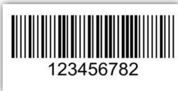
Slika 4. Prikaz jednodimenzionalnog barkoda
