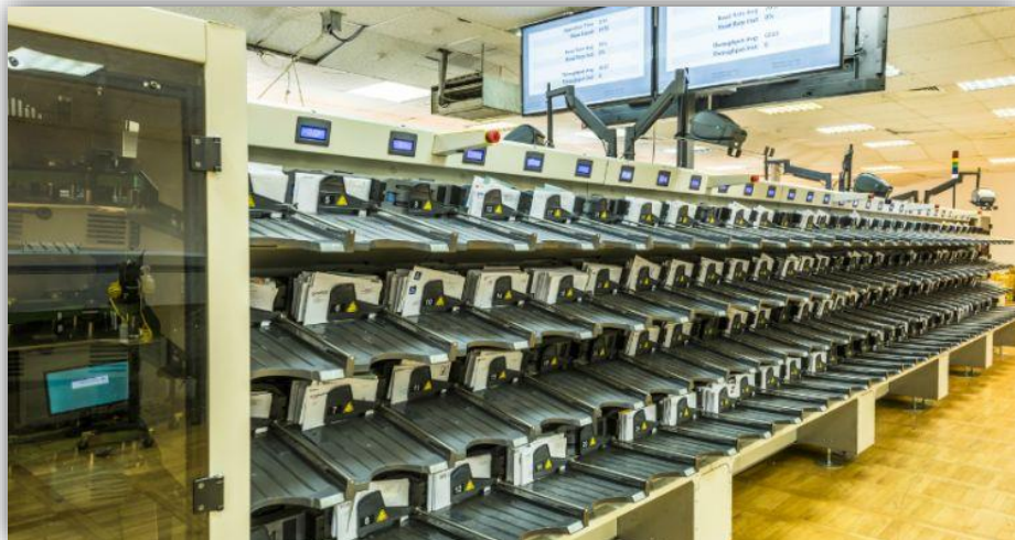
Slika 3. Prikaz stroja za automatsko sortiranje pismovnih pošiljaka Izvor: https://lider.media/wp-content/uploads/2017/10/SASP1.jpg (22.6.2019.)
