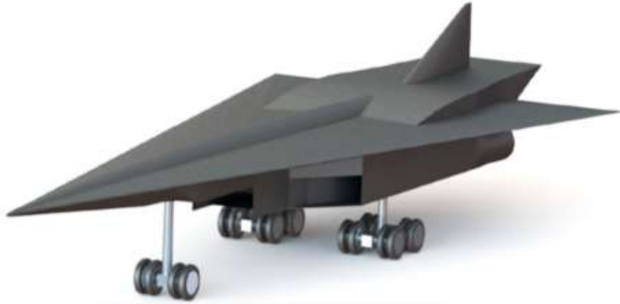
Slika 31. Koncept zrakoplova za hiperzvučni let [21]
