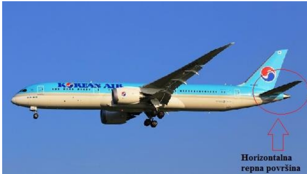
Slika 7.: Prikaz horizontalne repne površine na zrakoplovu Boeing 787 Dreamliner
