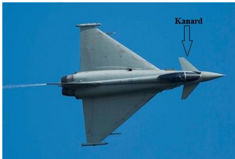
Slika 23.: Prikaz kanarda na borbenom zrakoplovu Eurofighter Typhoon
