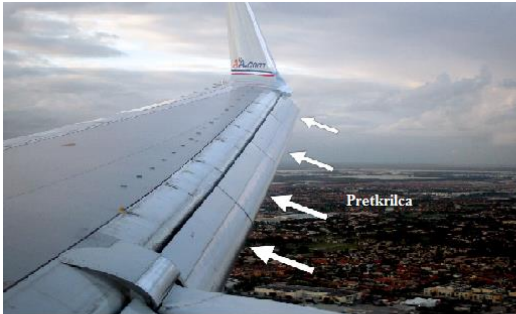
Slika 8.: Pretkrilca na krilu zrakoplova
