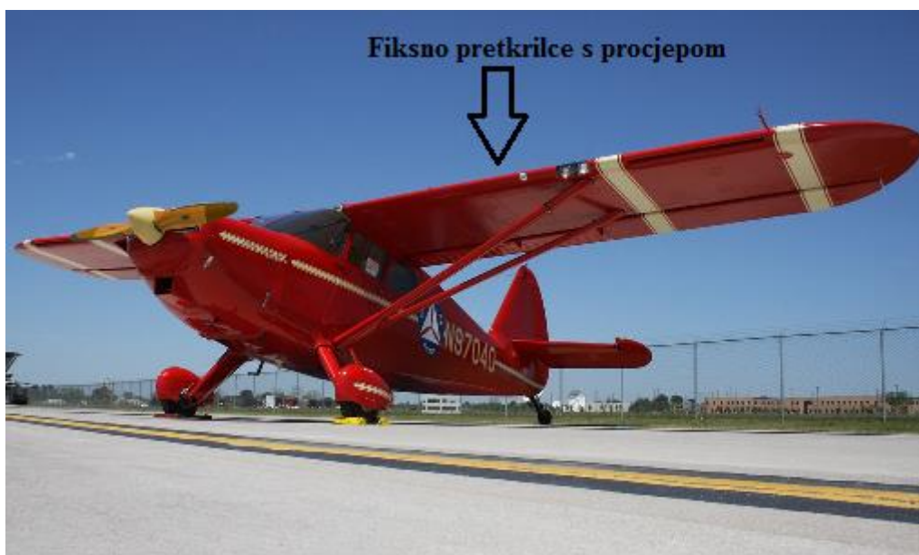
Slika 10.: Fiksno pretkrilce s procjepom na zrakoplovu Stinson 108-1
