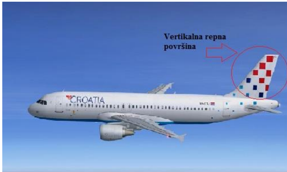
Slika 6.: Prikaz vertikalne repne površine na zrakoplovu Airbus A320
