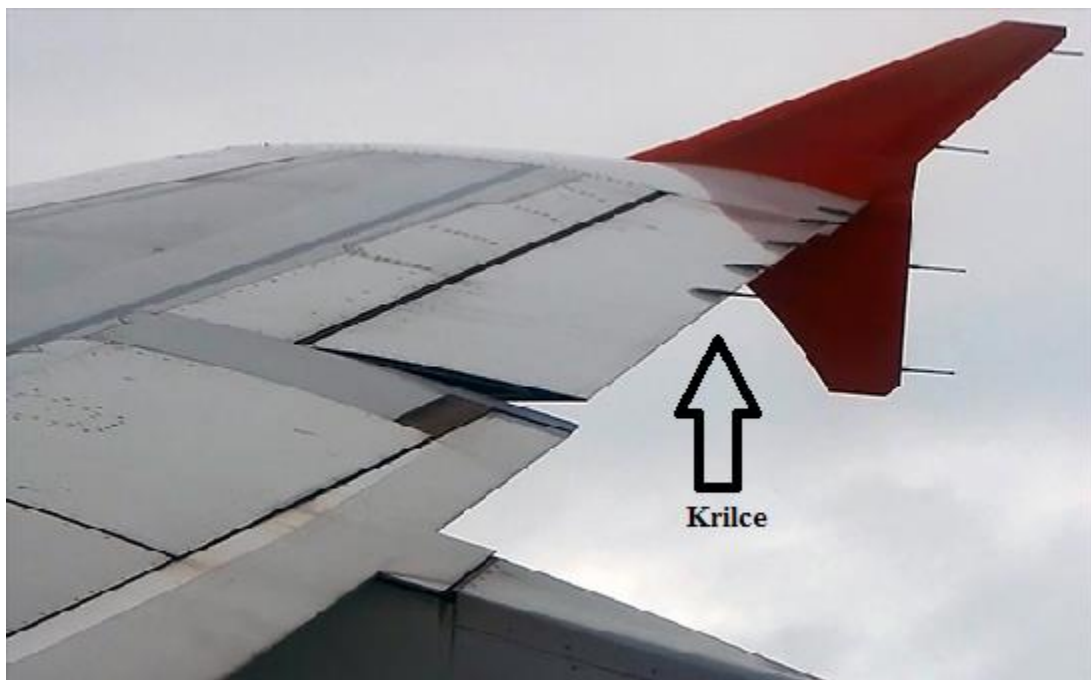
Slika 3.: Krilce otklonjeno prema gore na zrakoplovu Airbus A320
