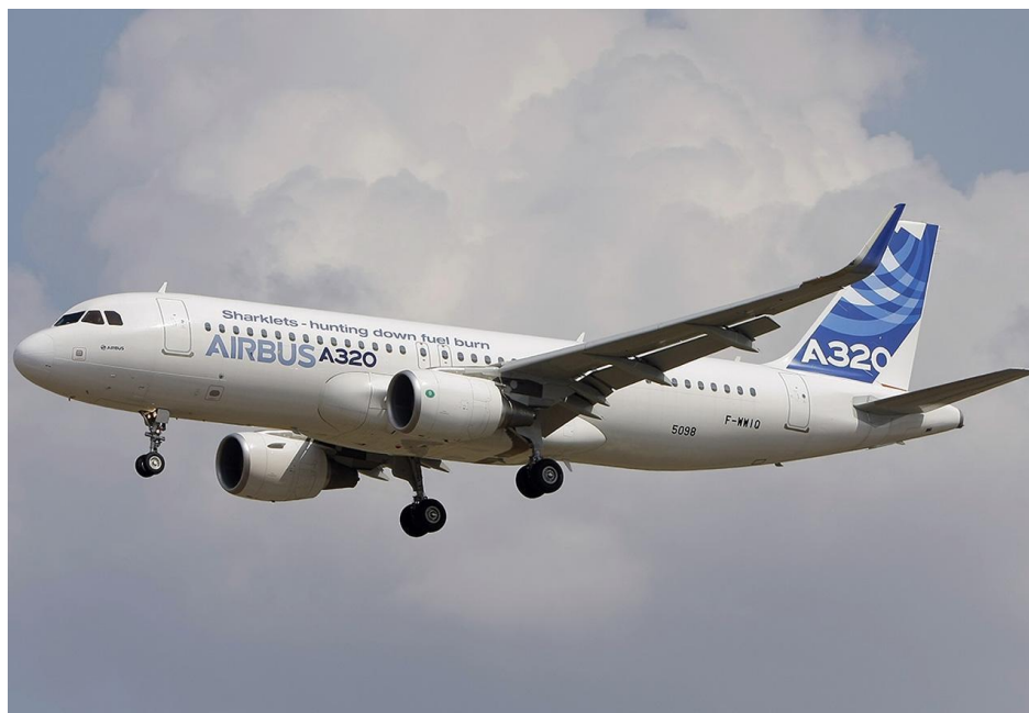
Slika 34.: Airbus A320 - Prvi komercijalni putnički zrakoplov sa "Fly by wire" sustavom upravljanja
