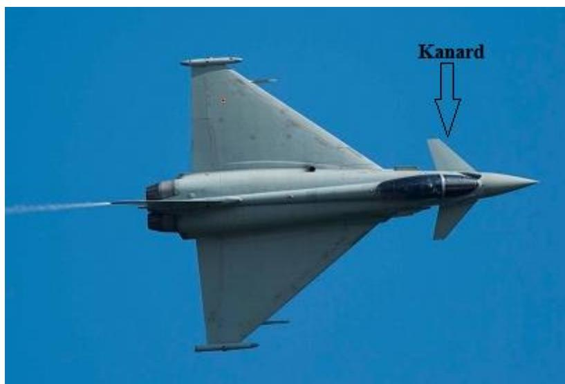
**Slika 23.: Prikaz kanarda na borbenom zrakoplovu Eurofighter Typhoon**
