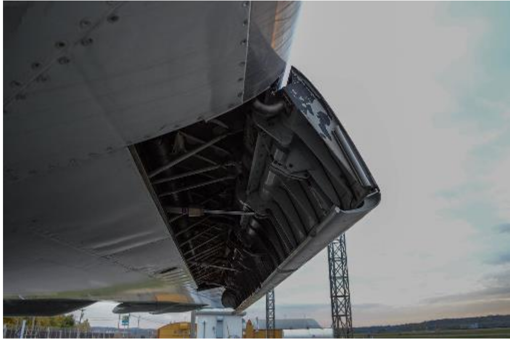
Slika 14.: Krugerovo pretkrilce na zrakoplovu Boeing 727
