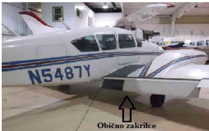
Slika 16.: Obično zakrilce na zrakoplovu Piper PA-23-250
