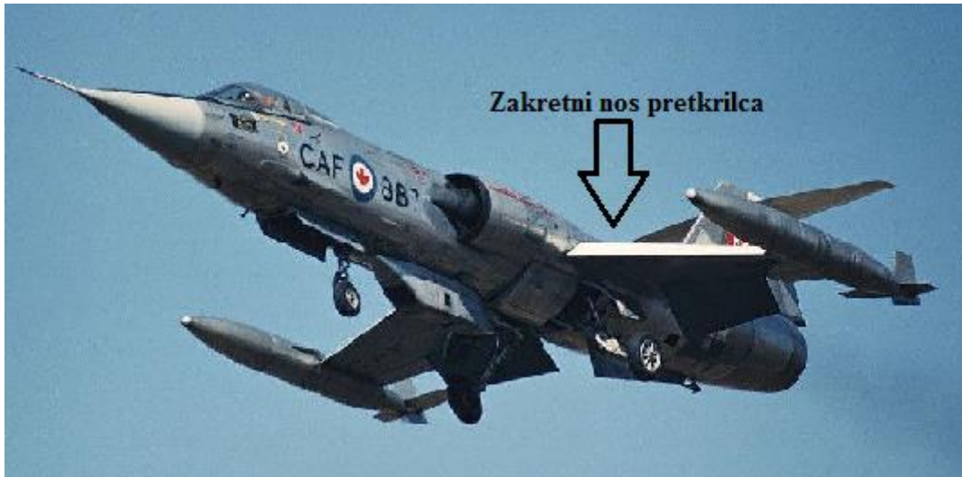
Slika 13.: Prikaz zakretnog nosa pretkrilca na zrakoplovu Lockheed F-104 Starfighter
