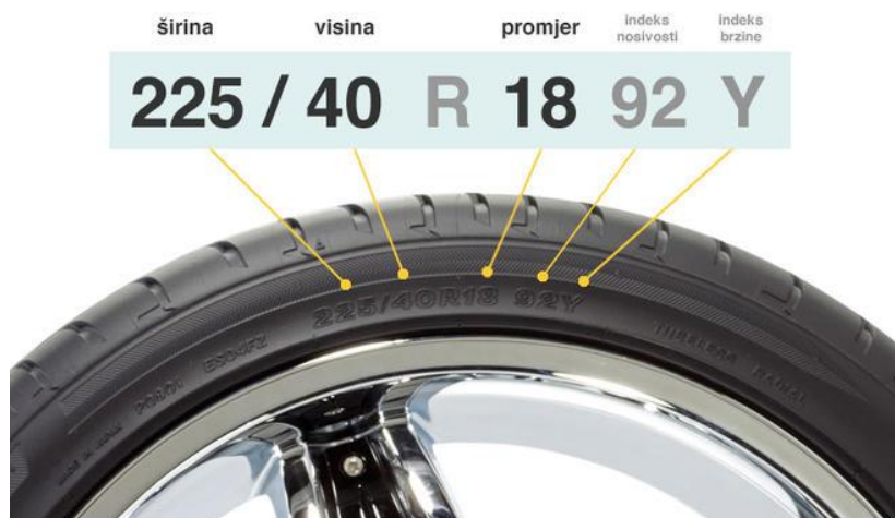
Slika 1. Osnovne veličine pneumatika
